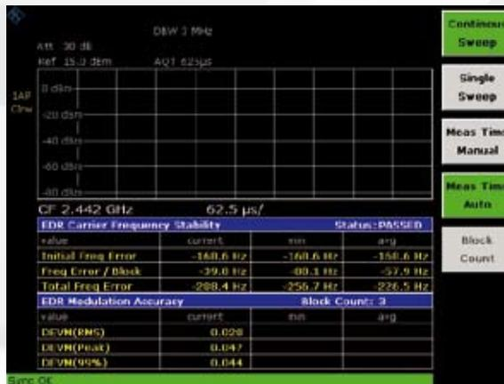
Trägerfrequenzbeständigkeit und Modulationsgenauigkeit Diese Messung bestimmt den Paket-Header, die Frequenzabweichung innerhalb des DPSK-Teils, sowie die DEVN-Metrik
